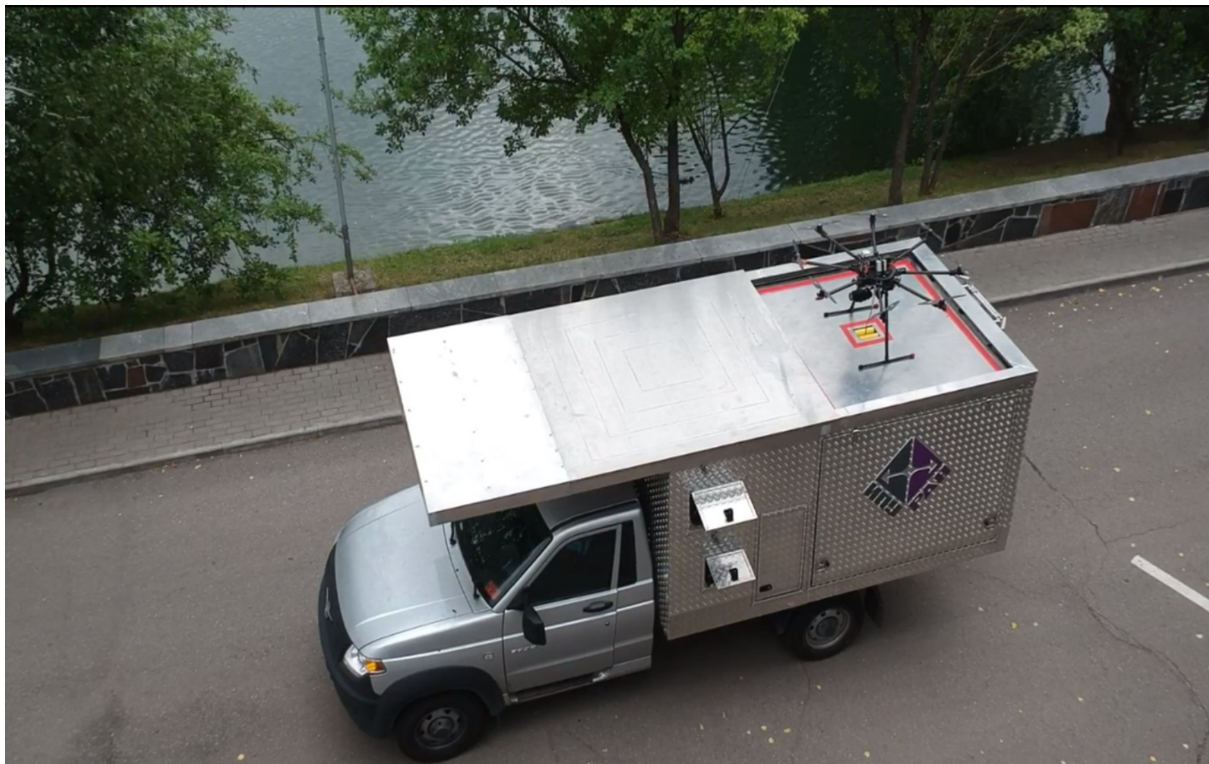
Мобильный робототехнический комплекс на базе привязной высотной беспилотной платформы «Альбатрос»
