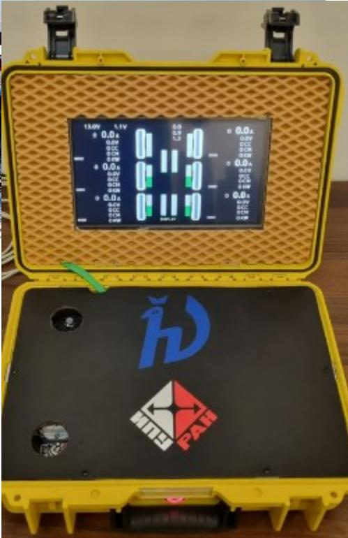
СТЕНД ДЛЯ ИССЛЕДОВАНИЯ БЛОКОВ УПРАВЛЕНИЯ МОДУЛЬНЫМИ
