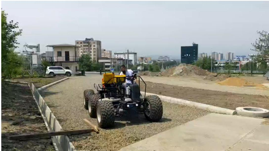
Вездеход с независимым электроприводом каждого колеса
