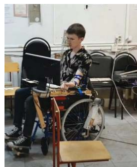
Инвалидная коляска, управляемая активностью одной группы мышц пользователя
