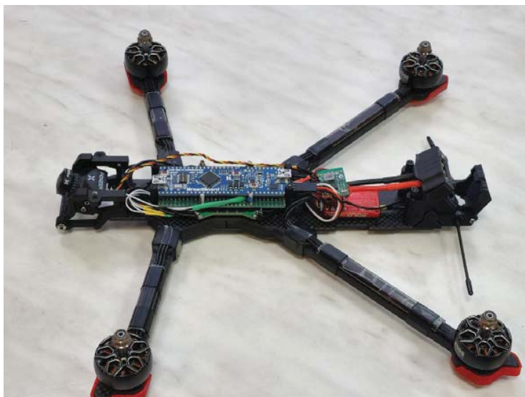
Опытный образец разрабатываемого полетного контроллера на борту современного FPV дрона
