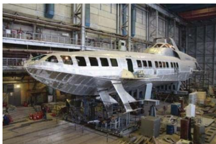
Строительство и спуск на воду морского судна на подводных крыльях нового поколения «Комета-120М» в 2017 г.
