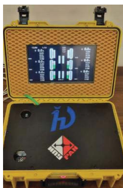
Внешний вид стенда для исследования блоков управления модульными многомоторными электрическими платформами (с примерами экспериментальных образцов)
