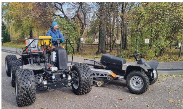
Внешний вид стенда для исследования блоков управления модульными многомоторными электрическими платформами (с примерами экспериментальных образцов)
