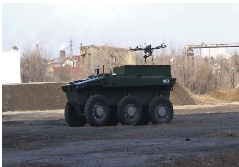
Рис. 5. Мобильная привязная высотная беспилотная платформа «Альбатрос» на базе робота разработки НПО «Андроидная техника»
