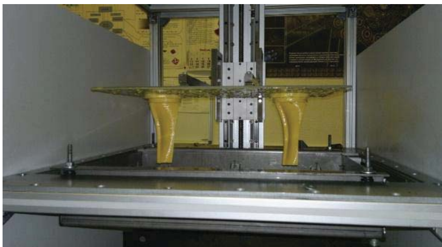
Установка для изготовления сложных прототипов деталей методом послойного отвердевания полимеров модель “350”
