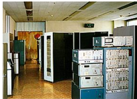
ЦУП-М: пара ПС-2000 из 32 ПЭ (на дальнем плане), подключённая к суперкомпьютеру "Эльбрус-2"
