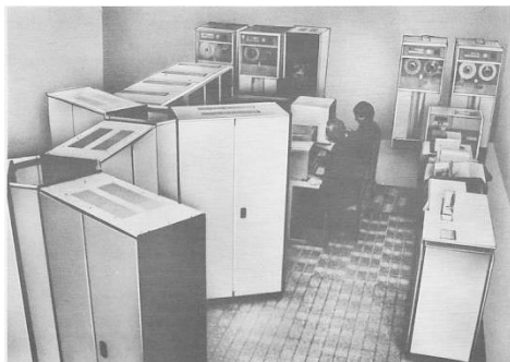
ВК ПС-2000 в конфигурации из 64 ПЭ, на переднем плане слева – видны четыре стойки из пяти
