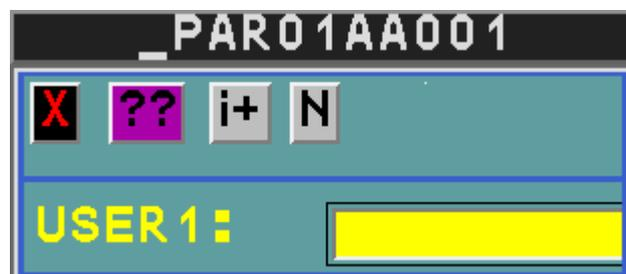
Рис. 2.5.2. Формат управления задвижкой, относящейся к группе USER1, и с полем для вывода пароля
