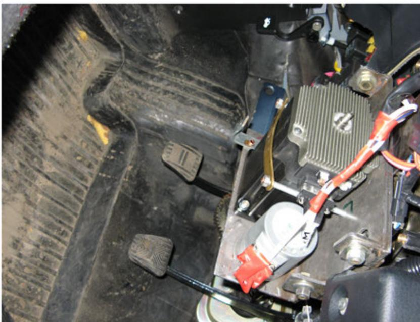
**Подготовка к тестированию системы управления колёсным роботом, повторяющим ранее запомненный маршрут с сантиметровой точностью (лаб. № 16)**
