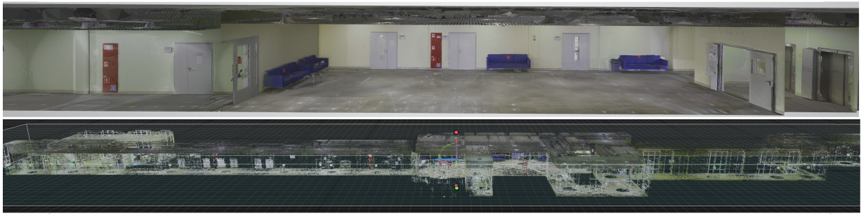
Рис. 12 — На нижнем изображении показано, как выглядит облако точек до нанесения текстур. Верхнее изображение это облако точек после нанесения текстур в программе RealityCapture.
