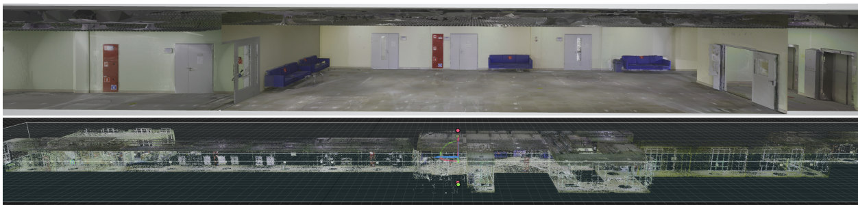
Рисунок 3.8 — На нижнем изображении показано, как выглядит облако точек до нанесения текстур. Верхнее изображение это облако точек после нанесения текстур в программе RealityCapture.
