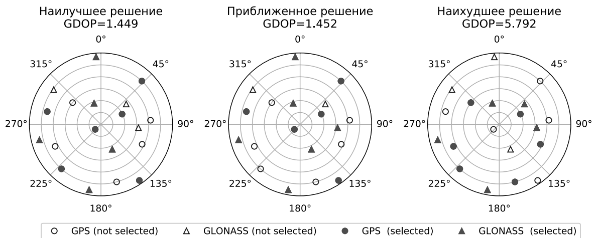
Рисунок 2.11 — Выбранное созвездие спутников для m = 11 в сравнении с наилучшим и наихудшим выбором
