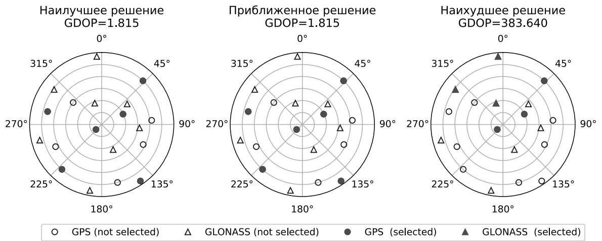
Рисунок 2.8 — Выбранное созвездие спутников для m = 6 в сравнении с наилучшим и наихудшим выбором
