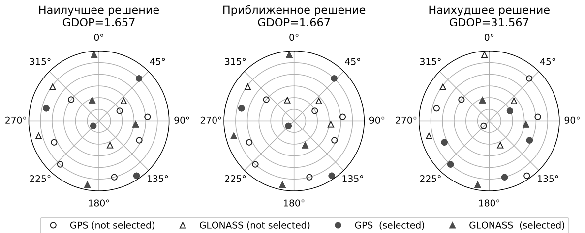
Рисунок 2.10 — Выбранное созвездие спутников для m = 8 в сравнении с наилучшим и наихудшим выбором
