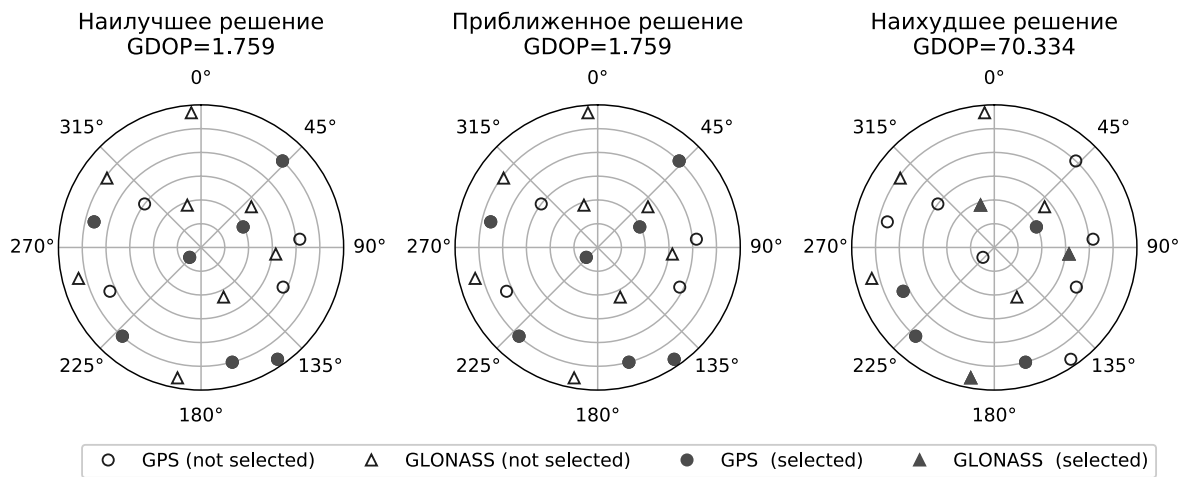
Рисунок 2.9 — Выбранное созвездие спутников для m = 7 в сравнении с наилучшим и наихудшим выбором
