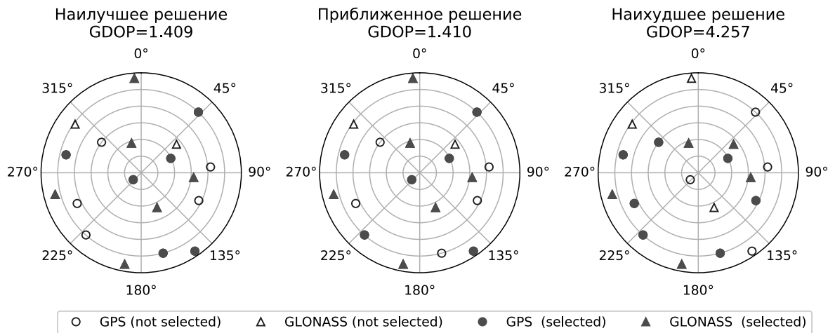
Рисунок 2.12 — Выбранное созвездие спутников для m = 12 в сравнении с наилучшим и наихудшим выбором
