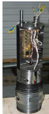
Рис. 2. Модуль телеметрии
