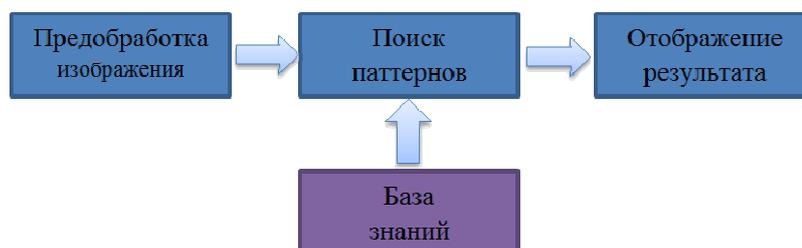
*Рис. 1. Алгоритм решения задачи классификации заданной мезоструктуры*
