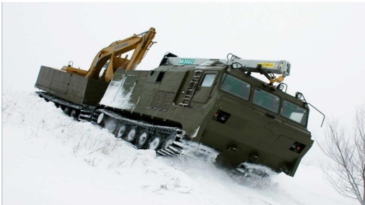
*Рис. 1. Двухзвенный снегоболотоход «Витязь»*
