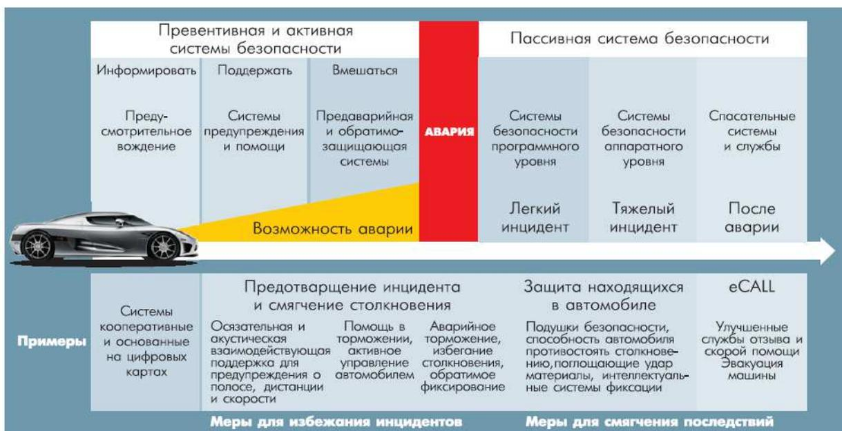
Рис. 2. Структура электронных систем поддержки управления
