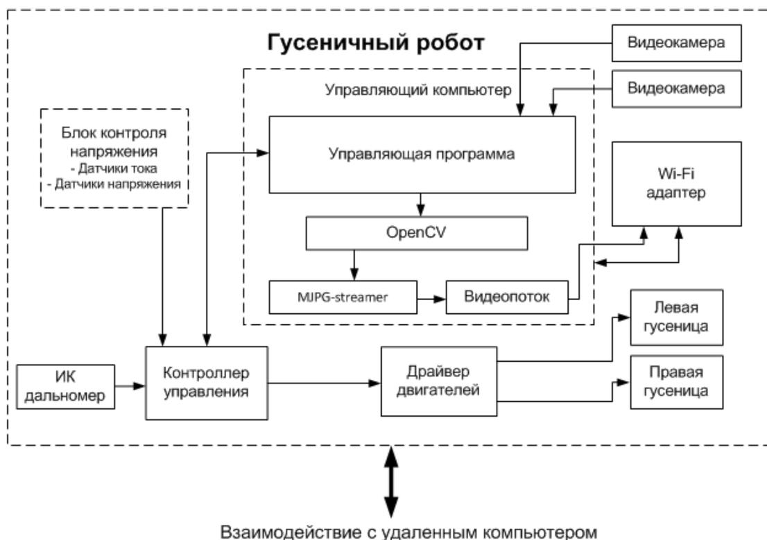
Рис. 2. Организация системы управления гусеничного робота
