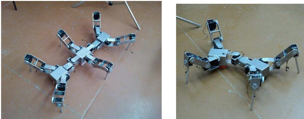
*Рис. 1. Реконфигурируемый мобильный робот «Легион»*
