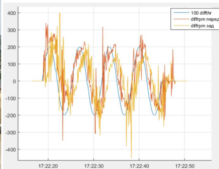
Идентификация угла поворота колёс по сигналам RPM
