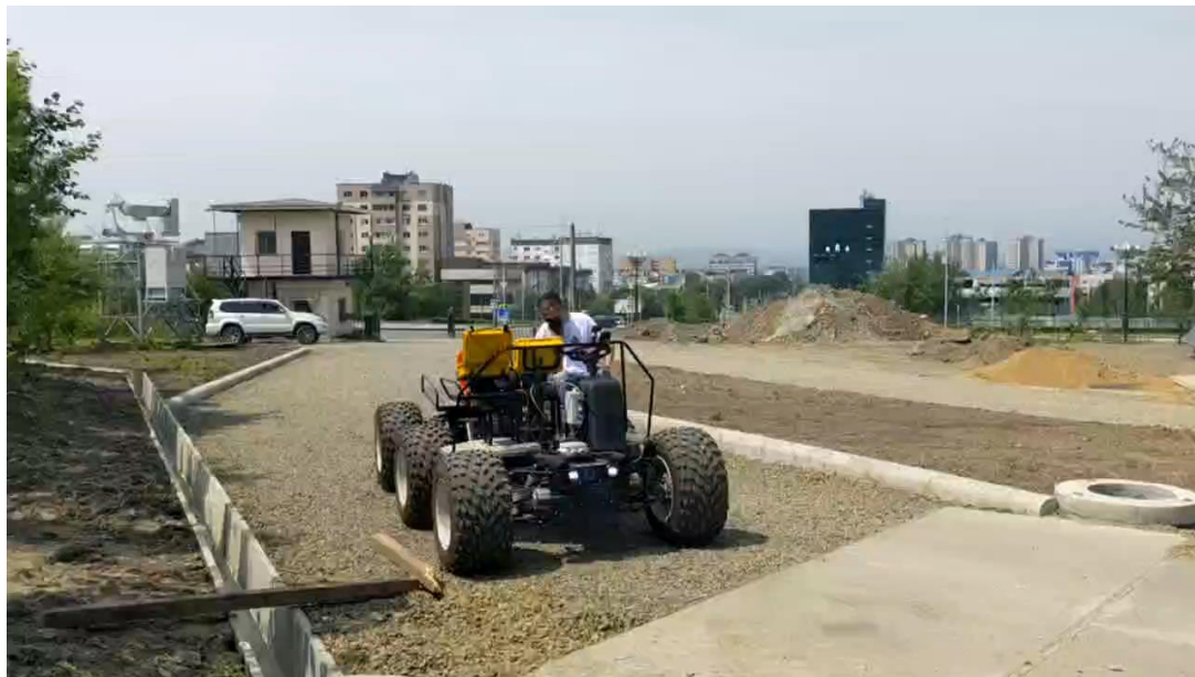
Вездеход с независимым электроприводом каждого колеса «Гексамоторная платформа Полевой-6»
