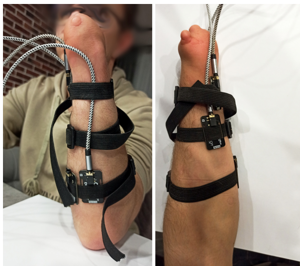
Рис. 2.17. Схема подключения ЭМГ датчиков.
