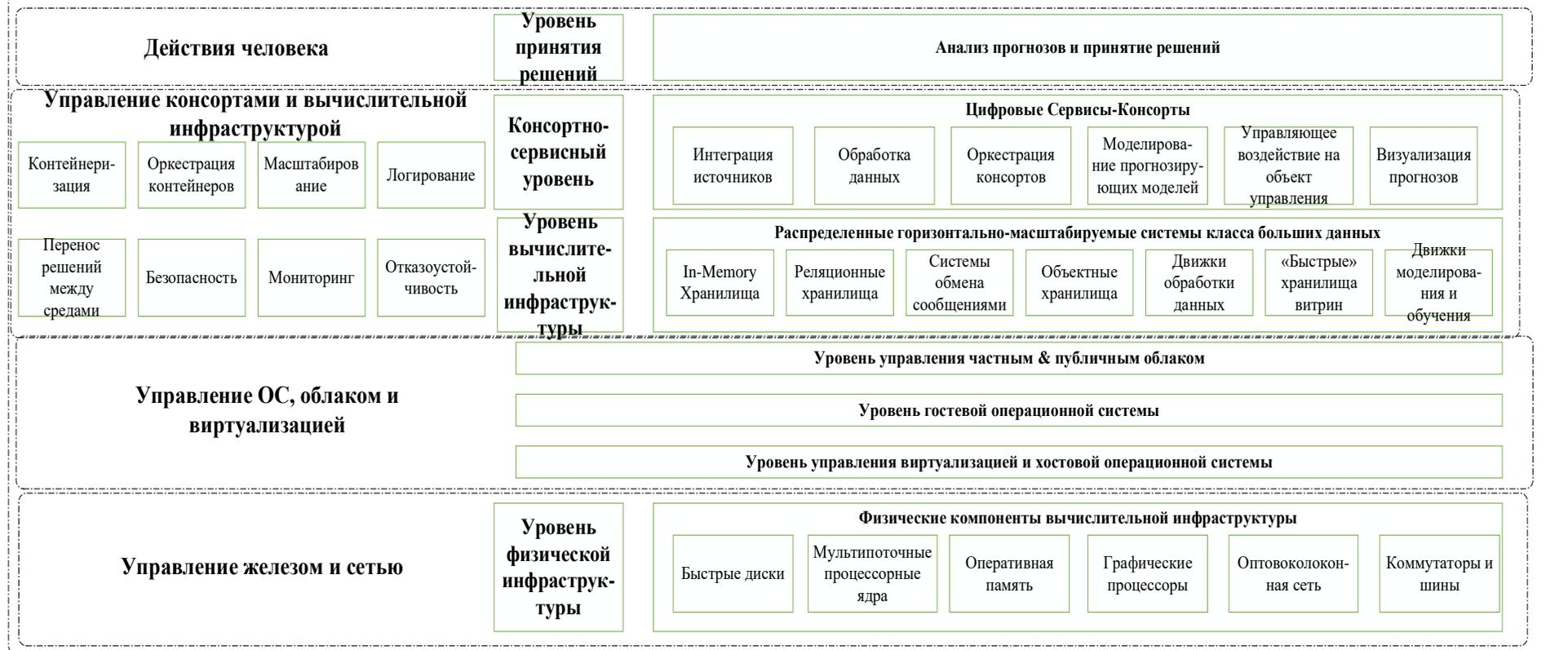
Рисунок 7. Концептуальная архитектура построения системы управления ресурсами производства в ЦЭС предприятия
