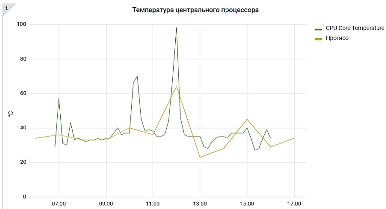
Рисунок 4. Пример прогнозирования температуры центрального процессора – прогнозируемые и фактические значения на интервале с 7.00 до 16.00
