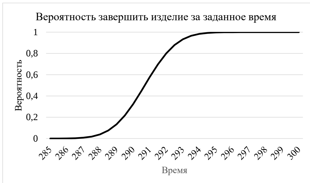
Рисунок 14 – Зависимость вероятности завершения изготовления изделия ТСП от времени его изготовления для улучшенного технологического процесса
