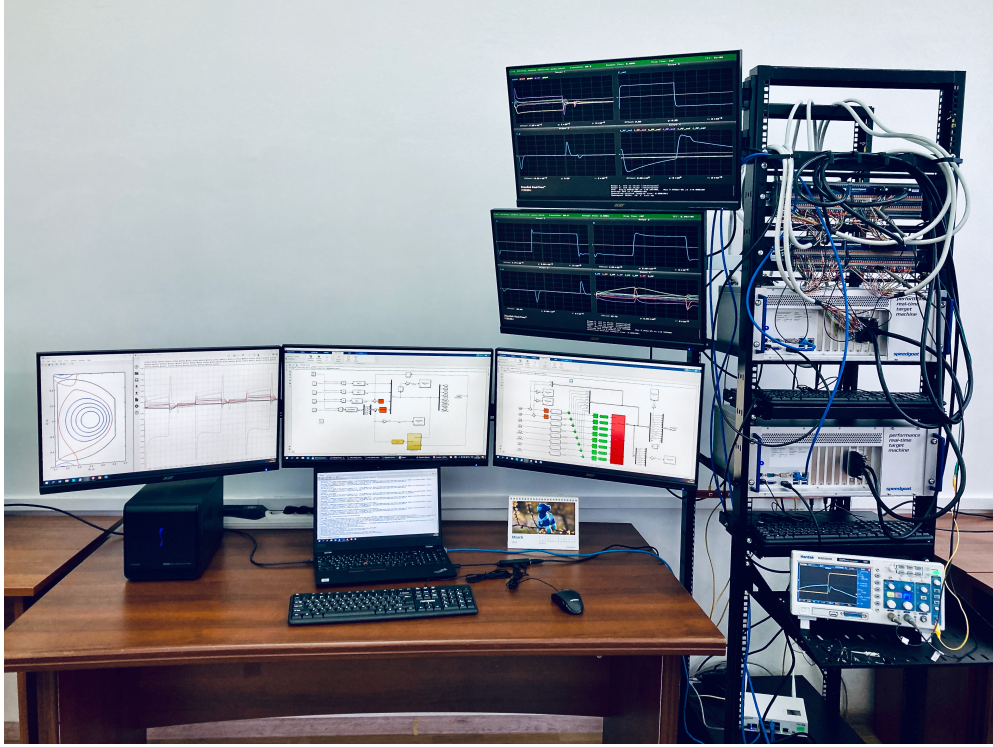
Рисунок 4.8 — Стенд реального времени для полунатурного моделирования систем управления плазмой в токамаке. Состоит из двух ЦМРВ, которые соединены по принципу обратной связи: один компьютер играет роль модели управляемой установки, а другой — многомерного регулятора
