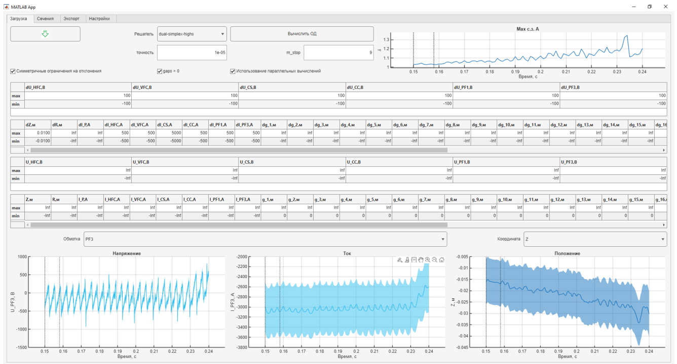
Рисунок 3.1 — Интерфейс приложения, вкладка «Загрузка» («Load»), Разряд № 41085. Доступен выбор ограничений на управляющие и выходные сигналы, показаны токи и напряжения в обмотках и область возможных отклонений по этим сигналам
