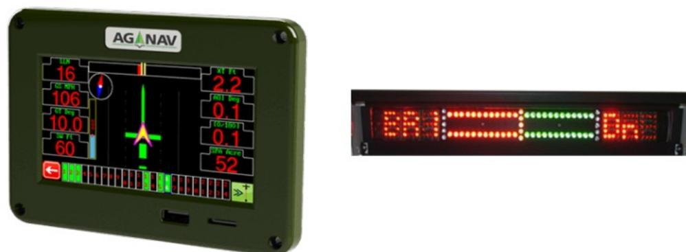
*Рисунок 1.3. Блоки-индикаторы системы AG-NAV: слева: интерактивный штурманский блок; справа: нуль-индикатор проводки*
