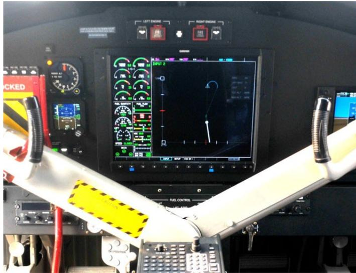
*Рисунок 1.8. Дисплей системы ASCEND в кабине пилотов*
