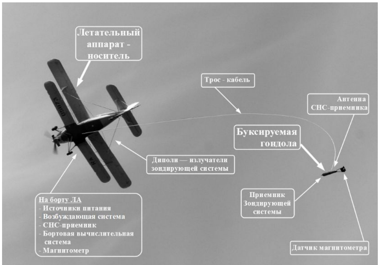
Рисунок 6.2. Общий вид и устройство комплекса EM4N
