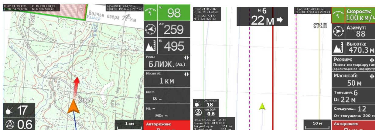
Рисунок 5.3. Представление навигационной информации в режимах захода на маршрут (слева) и проводки по маршруту (справа)
