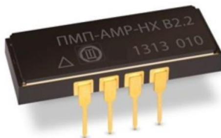
Фотоснимок анизотропного магниторезистивного преобразователя магнитного поля (ПМП-АМР) с нечетной вольт-эрстедной характеристикой в восьмивыводном, металлокерамическом, немагнитном, герметичном корпусе. Разработка НПК ТЦ с использованием результатов ИПУ РАН
