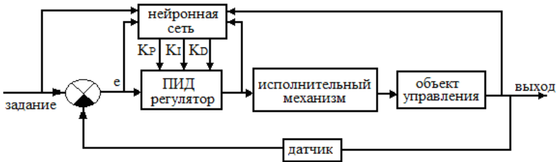
Рис. 1. Схема управления с нейросетевым оптимизатором параметров регулятора
