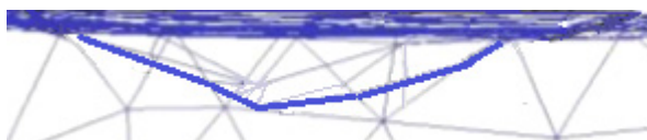
Рис. 6. Формоизменение дефекта при \varepsilon_{\Sigma} = 35,11\% и \mu = 0,07
