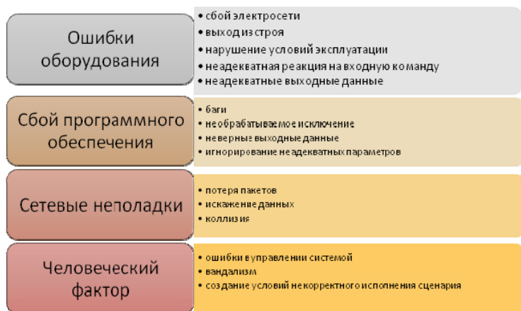
Рис. 1. Модель внутренних угроз безопасности «умного дома»
