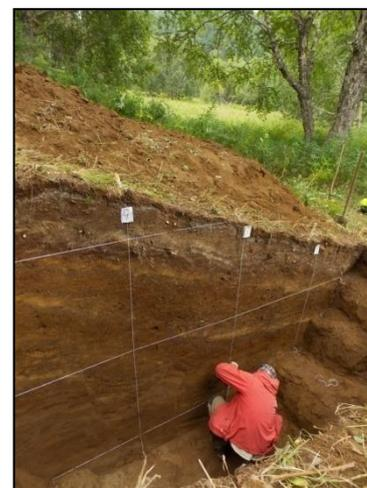
*Рис. 2. Канавы, вскрывающая разлом. Виден ППЧ (светлые слои – пирокластический материал, темные – почва). Фото Мишурина Д.В.*
