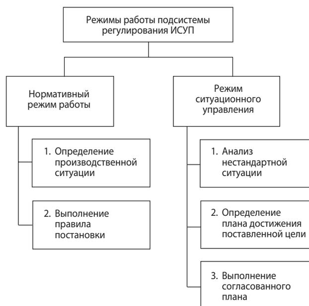
Рис. 4. Режимы работы подсистемы регулирования ИСУП
