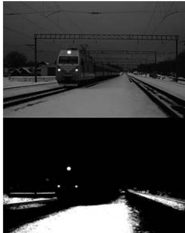
Рис. 5. Исходное и обработанное изображение встречного состава с включенными световыми сигналами в ночное время при отсутствии паразитной засветки
