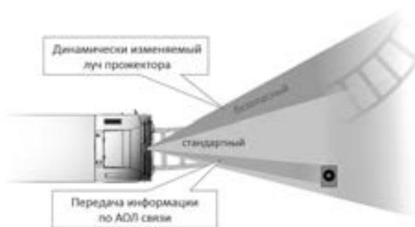
Рис. 6. Реализация динамически изменяемого луча прожектора и передачи информации по открытому атмосферному каналу связи
