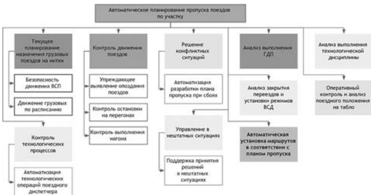
Рис.2. Комплексы задач ИСУЖТ по построению плана пропуска поездов
