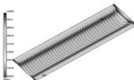
Рис.11. Эквивалентные напряжения (до 82 МПа) от распределенного равномерного аэродинамического давления на боковую стенку ( $C_p=1.5$ ) при скорости 250 км/ч
