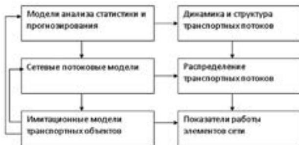
Рис.1. Комплекс взаимосвязанных математических моделей для решения проблемы выбора эффективных параметров технологии перевозочного процесса и развития сети
