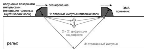
Рис.4. Схема метода бесконтактной лазерно-ультразвуковой дефектоскопии рельсов
