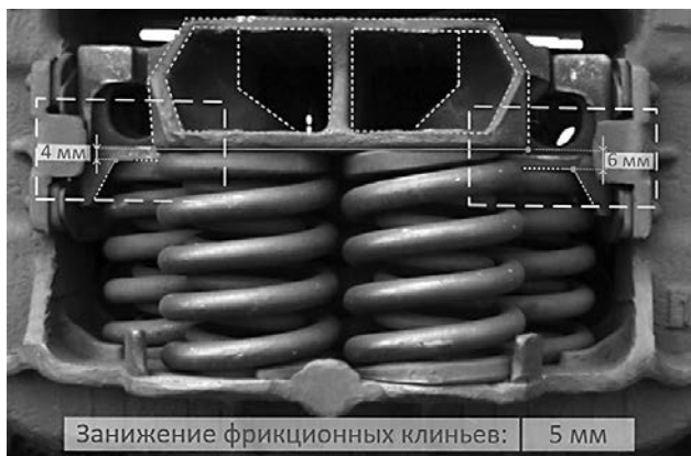
Рис.3. Пример определения занижения/возвышения фрикционных клиньев
