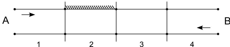
Рис.3 Двухпутная железная дорога с закрытым участком дороги
