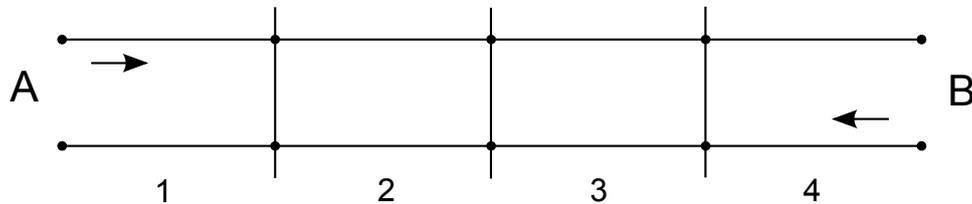
Рис.1 Двухпутная железная дорога, разделенная семафорами
