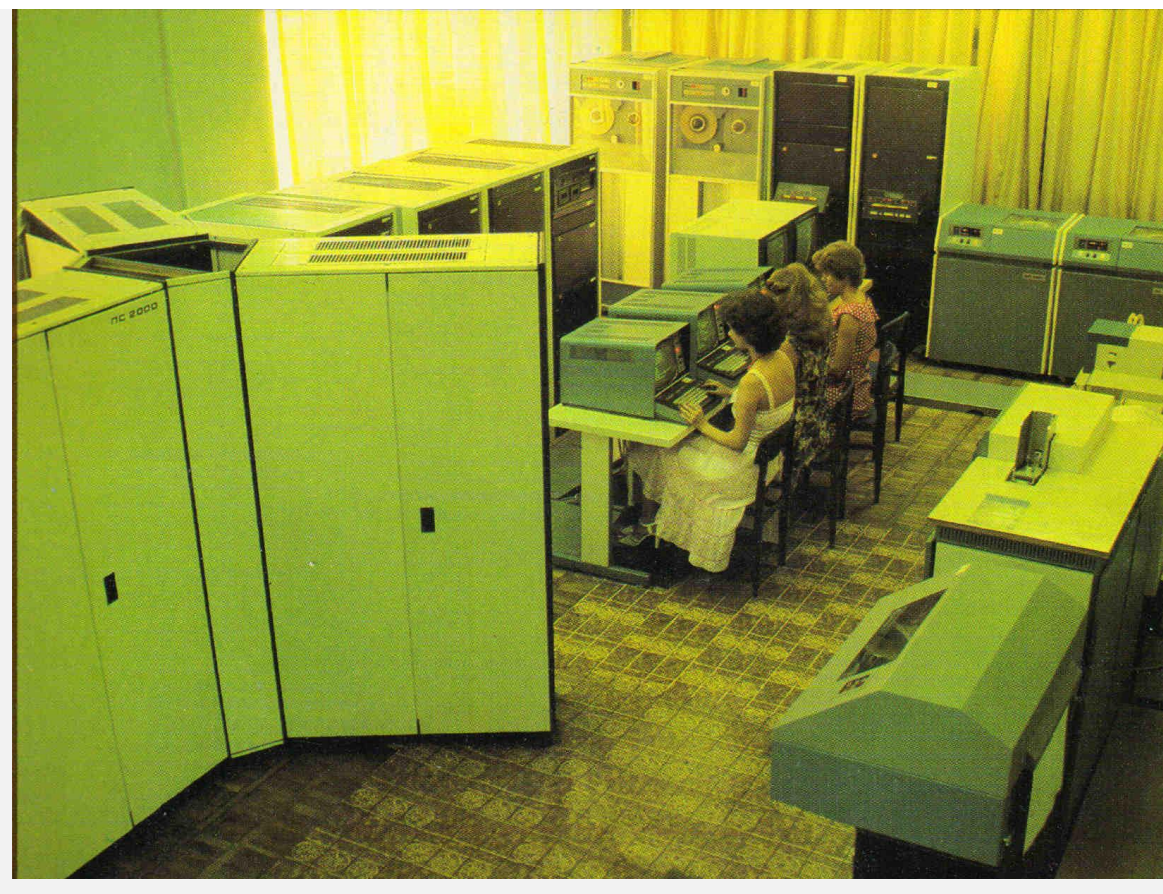
Рис. 5.1. Многопроцессорный компьютер ПС2000 (на переднем плане видны четыре из пяти стоек)
