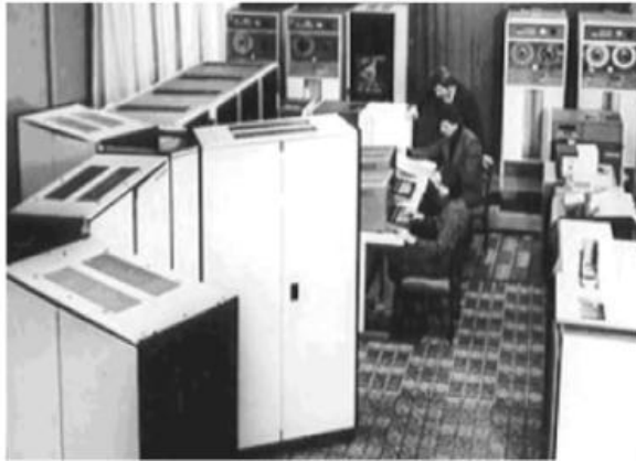
Рис. 2. Многопроцессорный компьютер ПС2000. На переднем плане видны четыре из пяти стоек
