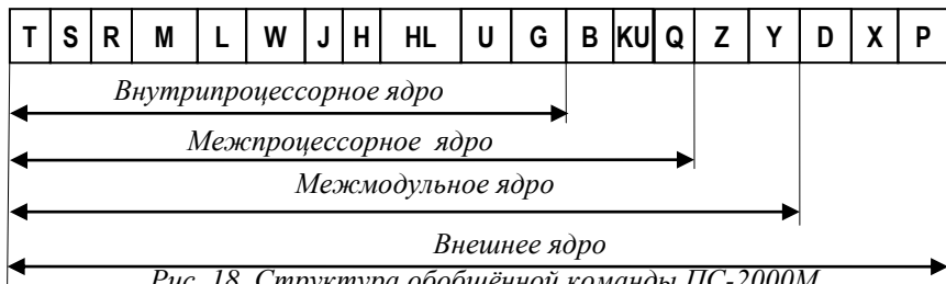
Рис. 18. Структура обобщённой команды ПС-2000М
