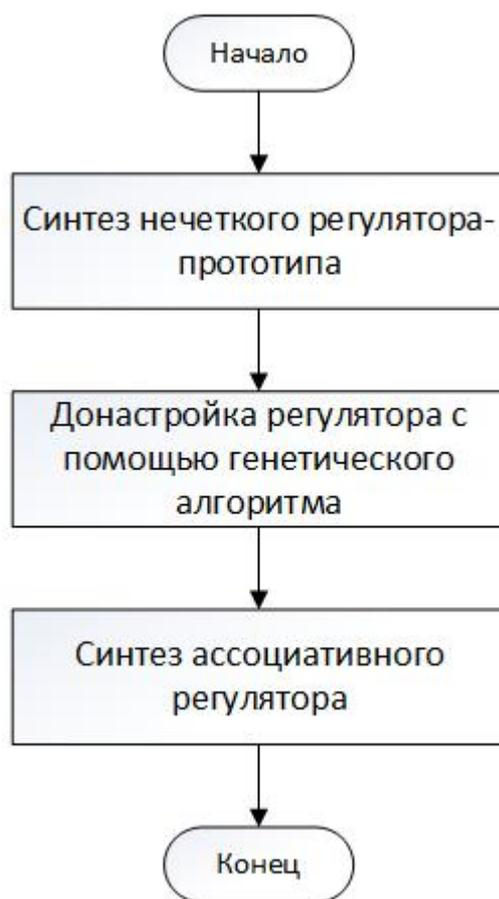
*Рис. 1. Схема алгоритма синтеза регулятора*
