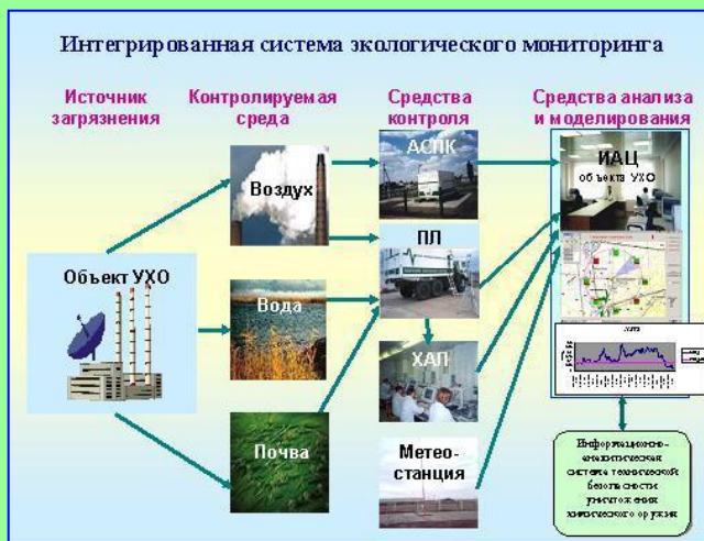
Система экологического мониторинга из проекта УХО (лаб. № 46)
