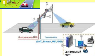
Идентификация транспортных средств с использованием RFID- технологии и широкополосной беспроводной связи
