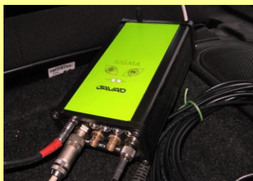
Приёмник GPS и тестирование колёсного робота, отслеживающего путь с точностью до сантиметра (лаб. № 16)
